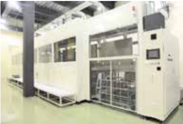
大型精密洗浄機 (洗浄層4層+乾燥層1層)
