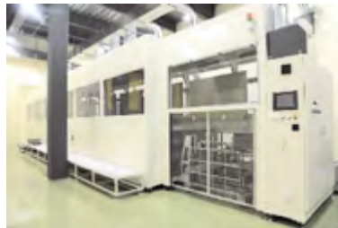
大型精密洗浄機 (洗浄層4層+乾燥層1層)
